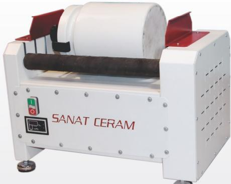
از این دستگاه به منظور آسیا کردن مواد در جارهای استوانه‌ای استفاده می‌شود. دستگاه فوق مناسب برای آسیای مقداری آزمایشگاهی مواد اولیه غیر فلزی معدنی (خشک و تر) است. آسیا متشکل از ۲ رولر از جنس فولاد با روکش لاستیک برای گرداندن جارهای است. این جارها با گلوله، آب (در حالت تر) و مواد مورد آسیا پر می‌شوند.
