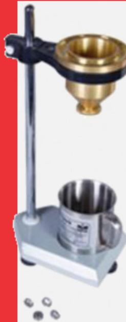
این دستگاه برای سنجش آسان و دقیق ویسکوزیتیه دوغاب سرامیکی، روغن، عسل، گلیسیرین و محلولهای دیگر مورد استفاده قرار می‌گیرد. میزان زمان عبور محلول از نازل مورد نظر را با استفاده از کورنومتر می‌توان اندازه گیری کرد.
