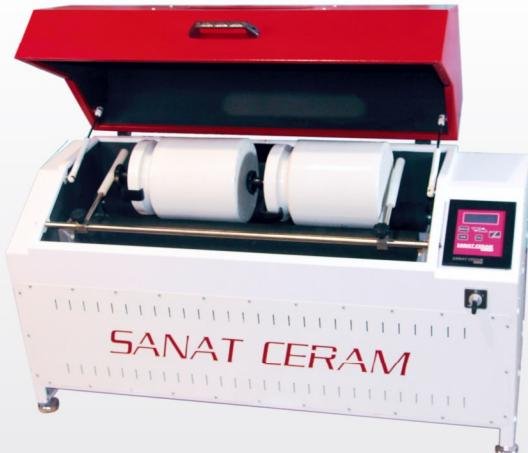
از این دستگاه به منظور آسیا کردن مواد در جارهای استوانه‌ای استفاده می‌شود. دستگاه فوق مناسب برای آسیای مقداری آزمایشگاهی مواد اولیه غیر فلزی معدنی (خشک و تر) است. آسیا متشکل از ۲ رولر از جنس فولاد با روکش لاستیک برای گرداندن جارهای است. این جارها با گلوله، آب (در حالت تر) و مواد مورد آسیا پر می‌شوند.
