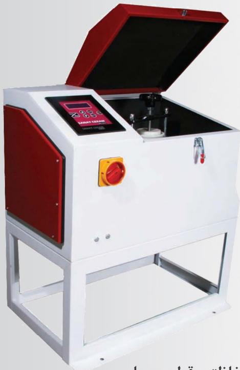
از این دستگاه برای آسیاب کردن سریع مواد اولیه مختلف غیر فلزی معدنی (خشک و تر) از جمله مواد سرامیکی، رنگ، غذا، آرایشی، دارویی، آزمایشگاهی، مدارس و ... استفاده می شود.
