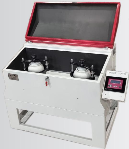
از این دستگاه برای آسیاب کردن سریع مواد اولیه مختلف غیر فلزی معدنی (خشک و تر) از جمله مواد سرامیکی ، رنگ ، غذا ، آرایشی ، دارویی، آزمایشگاه ها، مدارس و ... استفاده می شود.
