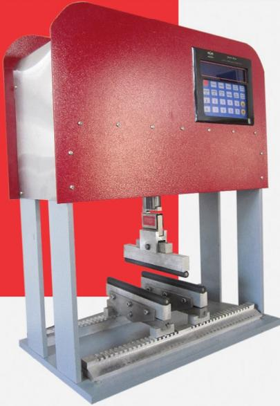
این دستگاه به منظور سنجش میزان مقاومت خمشی یک نمونه بر اساس استانداردهای فوق الذکر طراحی گردیده است: En 520, DIN 51030, ASTM C 84-648, ISO 10545-4
