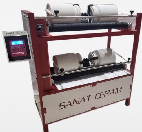
از این دستگاه به منظور آسیا کردن مواد در جارهای استوانه‌ای استفاده می‌شود. دستگاه فوق مناسب برای آسیای مقادیر آزمایشگاهی مواد اولیه غیر فلزی معدنی (خشک و تر) است. آسیا متعدد کل از ۴ رولر از جنس فولاد با روکش لاستیک برای گرداندن جارهای است. این جارهای با گلوله، آب (در حالت تر) و مواد مورد آسیا پر می‌شوند.
